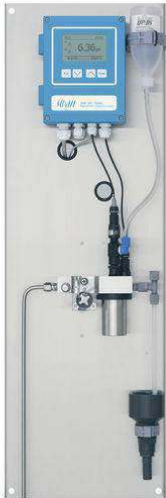
MEDIDOR DE PH Y CL 2 EN LÍNEA
